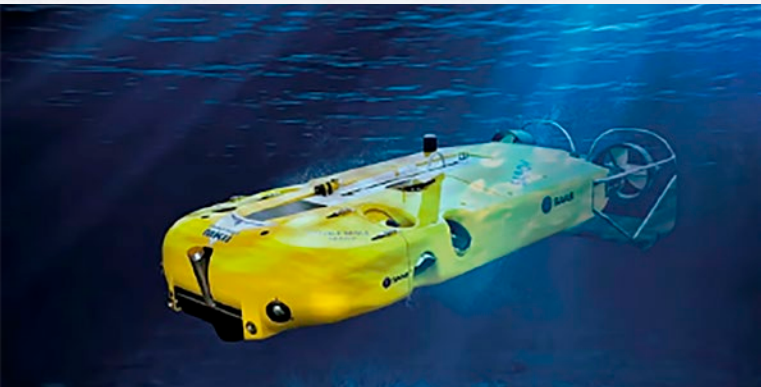
Dit onbemande onderwatervoertuig is een Double Eagle van het Zweedse defensiebedrijf Saab en wordt gebruikt voor het opsporen en onschadelijk maken van zeemijnen.
