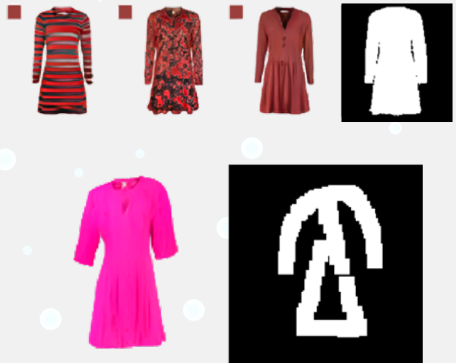
Boven de gecreëerde jurken door een GAN, waarbij de vorm en de kleurcombinatie vooraf bepaald zijn. Onder is het zwarte plaatje een met de hand geschetst kledingstuk. Het GAN maakt er automatisch een plausibel kledingstuk van.
