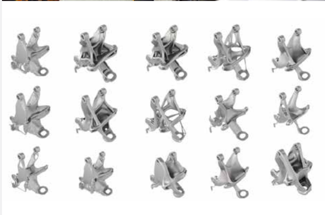
Boven 'generative design'-ontwerpen voor het bekende Volkswagen T2-busje, onder ontwerpen voor een General Motors-stoelbeugel waar de veiligheidsgordel aan wordt vastgemaakt.
