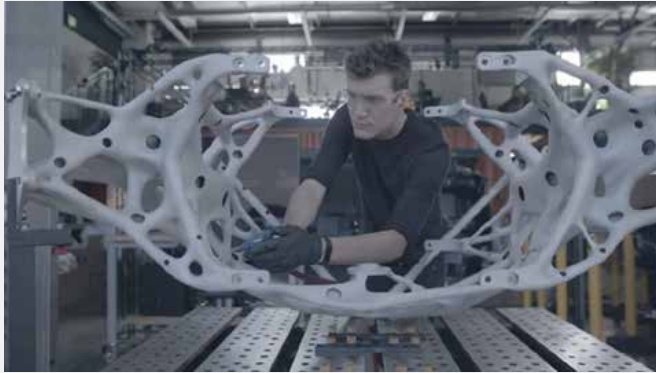
Generatief ontwerp van Autodesk voor NASA's verkenning naar Jupiter en Saturnus dat lichter en sterker is en alleen door 3D-printing kan worden gefabriceerd.
